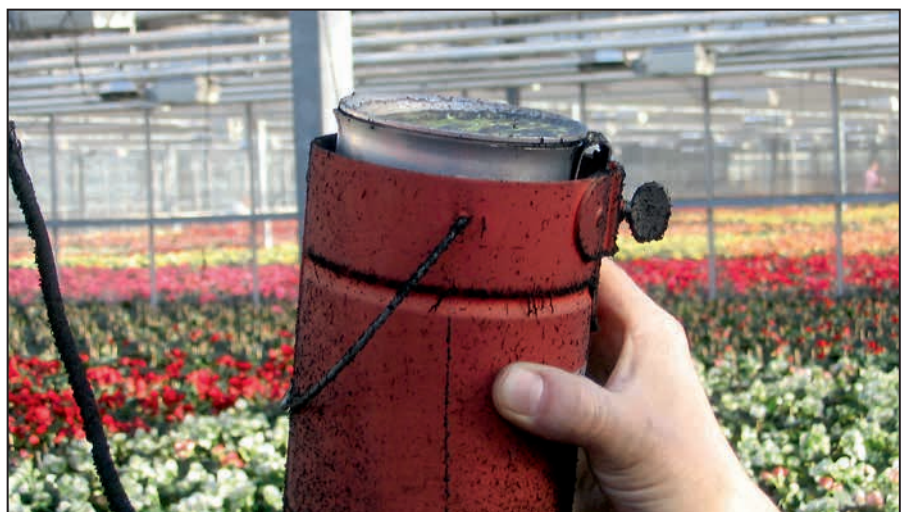
Foto 3: Il secchiello dello zolfo appeso non perpendicolarmente e riempito oltre il limite ha causato, in questo caso, un sinistro da incendio.
