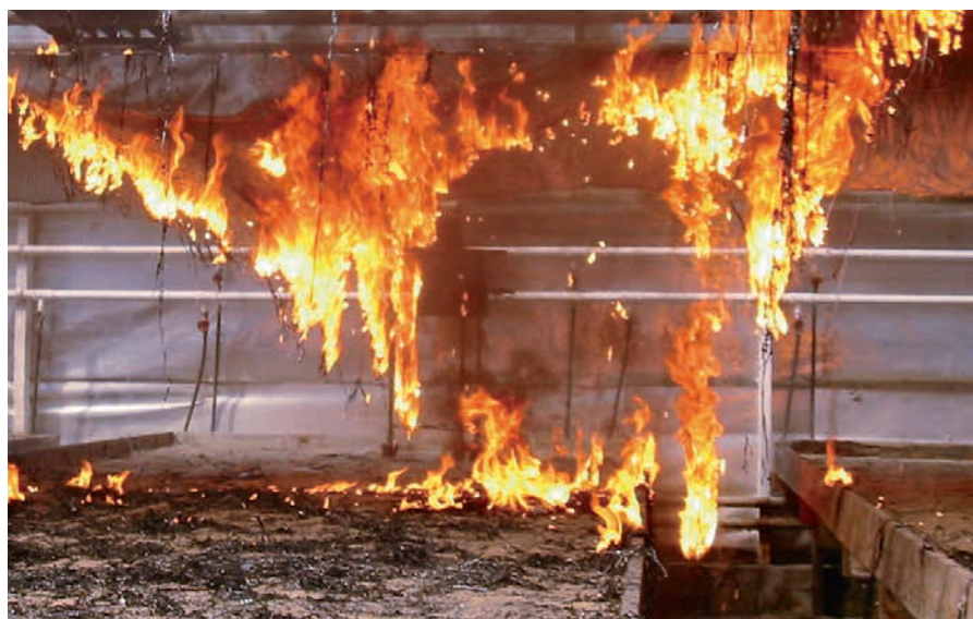
Foto 2: Schermo non ignifugo, il gocciolamento del materiale infiammato incendia i tappeti di plastica dei bancali sottostanti. Pericolo estremo di incendio totale dell'azienda!
